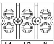
L1 L2 N INC. 115/230VAC TIGHTENING TORQUE FOR TERMINAL BLOCK IS 16 in-lbs.
