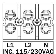
TIGHTENING TORQUE FOR TERMINAL BLOCK IS 16 in-lbs.
