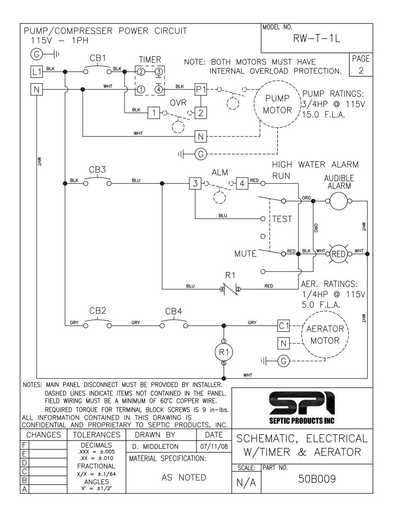
TIGHTENING TORQUE FOR TERMINAL BLOCK IS 9 in-Ibs.
